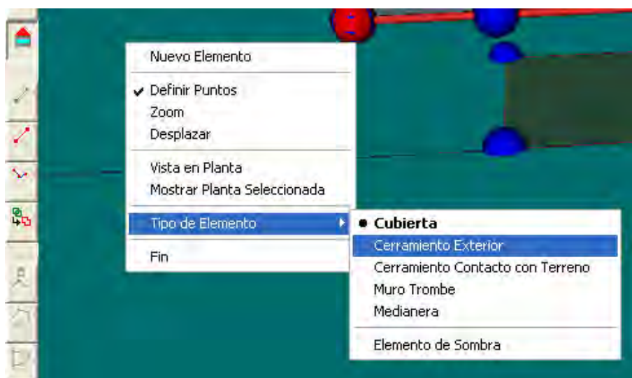
Figura 14.11: Creación de cerramiento exterior como elemento singular
