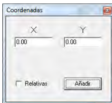
Figura 5.56: Introducción de coordenadas absolutas
