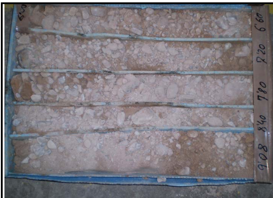
Sondeo S1. Caja 3. Profundidad: 6.00-9.08 m
